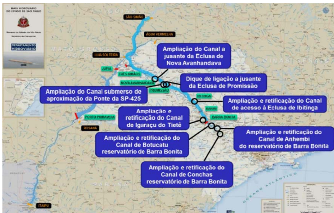
Figura 57. Intervenções previstas em canais na Hidrovia Tietê
