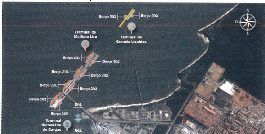
Figura 9 – Infraestrutura de acostagem do Porto de Vila de Conde
