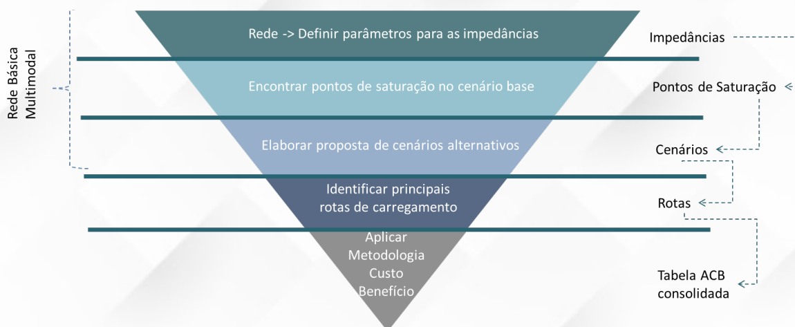
Figura 1- Etapas do processo de planejamento de transportes.
