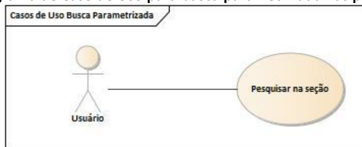
Figura 19. Diagrama de Caso de Uso para busca parametrizada nas páginas do portal
