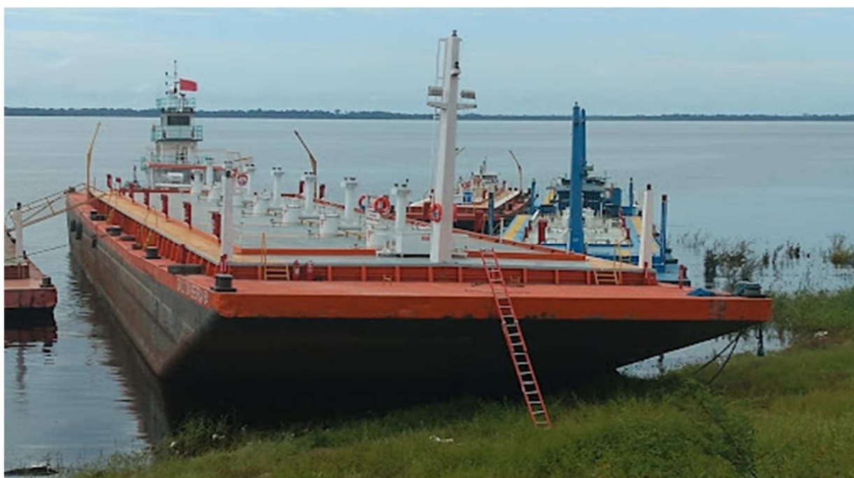
Figura 32. Balsa de armazenagem e transporte fluvial de Granéis Líquidos Combustíveis.
